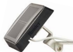
SPNODE Solarpanel-Kit (optional) Höhe: 8 cm Länge: 25 cm Breite: 8 cm Kabellänge Steuergerät zum Solarpanel: maximal 30 m 1-mm 2 -Kabel zur direkten Erdverlegung
