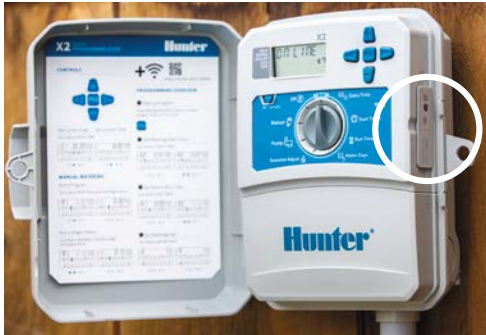
X2-Steuergerät mit installiertem WAND
