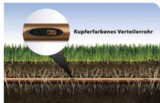
Unterirdisches Tropfrohr XFS mit Copper Shield™ Technologie
